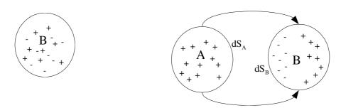
Considérons un tube de champ T qui découpe sur A et B des surfaces dS<sub>A</sub> et dS<sub>B</sub>, on montre que les charges portées par ces éléments sont opposées.  $dq_A + dq_B = 0$
