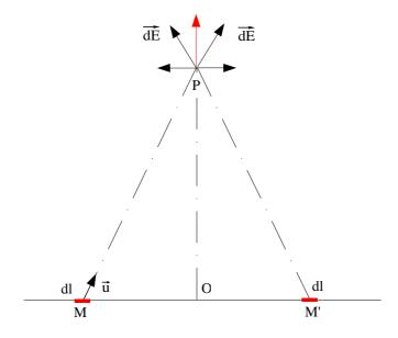
Vecteurs d  $\vec{E}$  crées par dq placés à l'infini de la droite:
