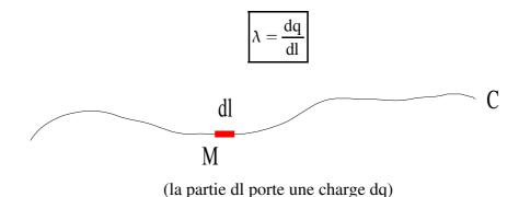
dq est la charge portée par un élément dl de la courbe, infiniment petit, entourant le point M. On définit alors le champ électrostatique  $\vec{E}$  en un point P par:
