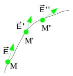
En chaque point de l'espace, il passe une ligne de forces et une seule. L'ensemble des lignes de forces passant par tout les points d'une ligne fermée est un tube de forces.
