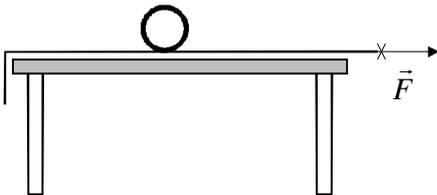
On considère un cylindre creux, de masse  $M$  et de rayon  $R$ , qui peut rouler sur une nappe que l'on tire avec une force non précisée, mais telle qu'il n'y ait jamais glissement entre le cylindre et la nappe. A  $t=0$ , la nappe et le cylindre sont immobiles.
