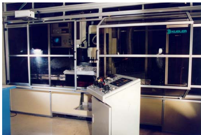
Usinage des KDP LMJ en Fly Cutting
