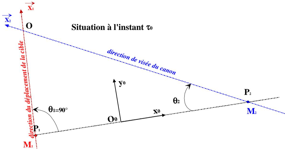
$$\sin\theta_2 = \frac{\|\vec{V}_{(M1/R_0)}\|}{\|\vec{V}_{(M2/R_0)}\|} = \frac{20}{300} \Leftrightarrow \theta_2 = 3,82^\circ \text{ et } \vec{P_1P_2} = a \cdot \vec{x}_0 \text{ avec } a = 300 \text{ m}$$
