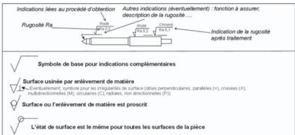
Figure 13.5 – Indications de la rugosité sur un dessin de définition.
