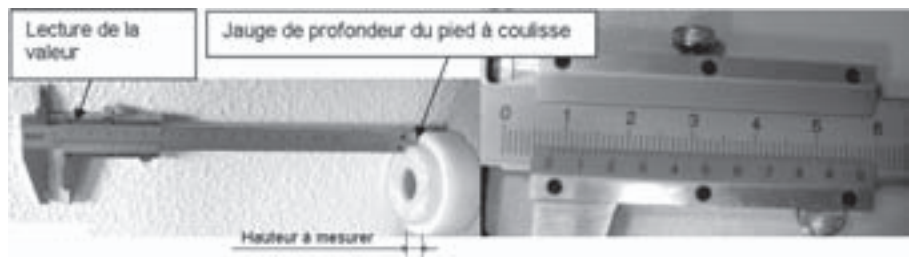
Figure 14.6 – Métrologie d'une profondeur avec un pied à coulisse.
