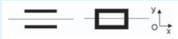
Figure 9.7 – Liaison pivot glissant.
