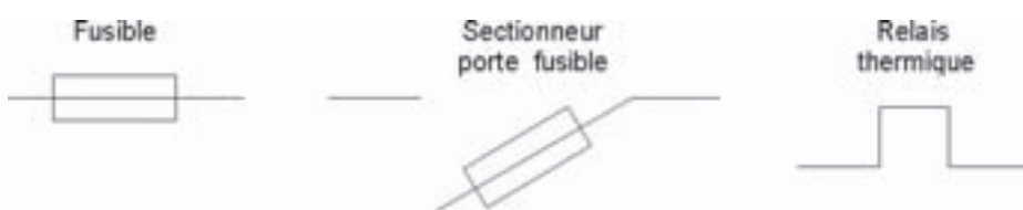
Figure 19.82b – Schématisation électrique CEI 61082.
