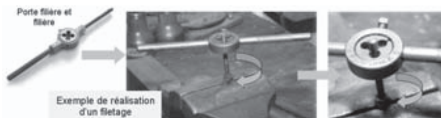
Figure 17.4 – Réalisation d'un filetage.
