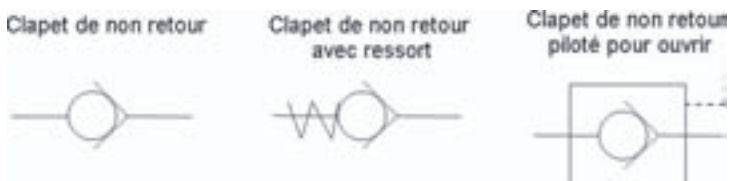
Figure 19.83b – Schématisation pneumatique et hydraulique NF ISO 1219.
