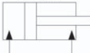
Vérin pneumatique double effet
