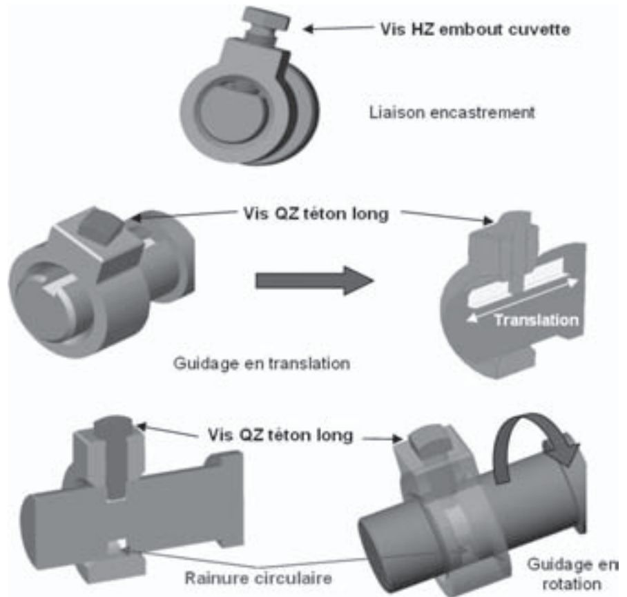
Figure 17.30 – Exemples d'application pour les vis de pression.
