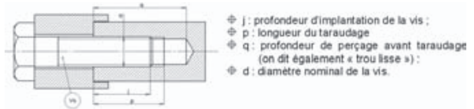
Figure 17.19 – Implantation d'une vis.
