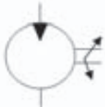
Pompe hydraulique à cylindrée fixe à un sens de flux et un sens de rotation
