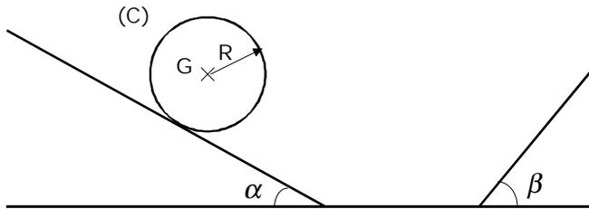
Un cylindre homogène de masse  $M$ , de rayon  $R$ , de centre d'inertie  $G$ , roule sans glissement sur un plan incliné.
