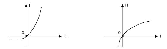
I.1. Caractéristiques : il s'agit des courbes I = f(U) et U = g(I), que l'on peut tracer par exemple expérimentalement, point par point. Les deux caractéristiques se déduisent par symétrie par rapport à la  $1^{\text{ère}}$  bissectrice.
