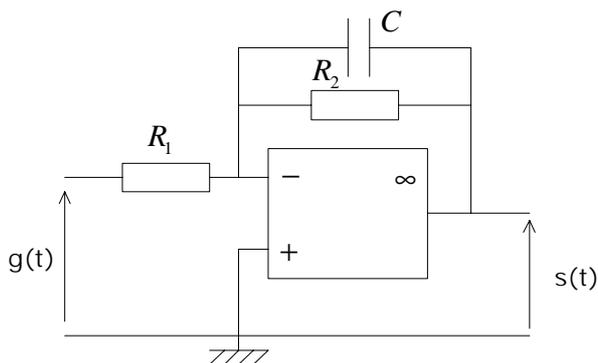
On donne :  $C = 1\mu F$  ;  $R_1 = 1k\Omega$  ;  $R_2 = 10k\Omega$
