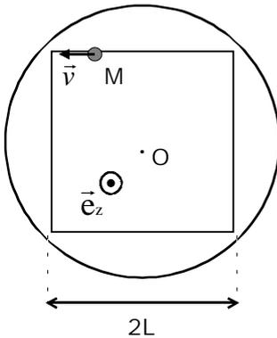
Un jouet est constitué d'un plateau circulaire pouvant tourner sans frottements autour d'un axe vertical  $Oz$ . Une piste carrée (de côté  $2L$ ) est aménagée sur le plateau; un mobile  $M$ , assimilé à un point matériel de masse  $m$ , peut se déplacer sur cette piste avec une vitesse  $v$  quelconque. Initialement, tout est immobile. A  $t=0$ , le mobile démarre et fait une fois le tour du carré.
