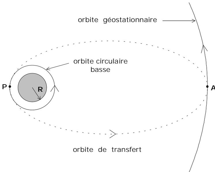
Pour placer un satellite en orbite géostationnaire, on l'envoie d'abord sur une orbite circulaire basse située à l'altitude :  $h_p = 200 \text{ km}$
