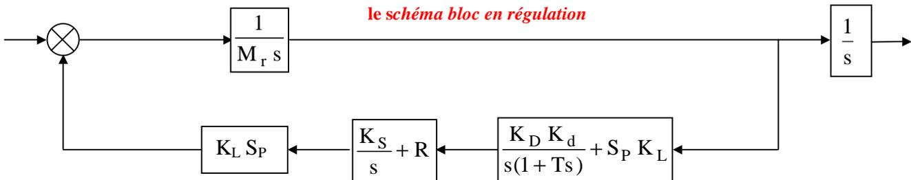
En régulation, la fonction de transfert de la suspension hydrodynamique en mode ferme s'écrit :
