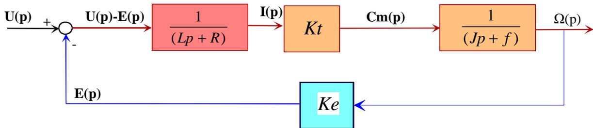
Le schéma devient sous forme canonique :
