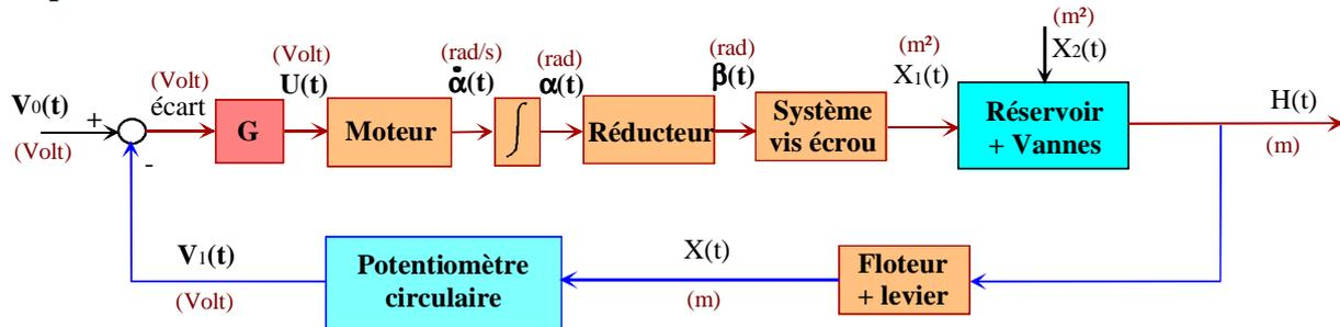
Schéma fonctionnel du système de régulation d'eau.
