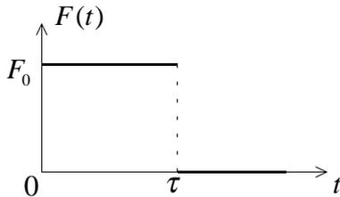
Le point  $M$  étant initialement au repos, on lui applique pendant un temps limité une force  $\vec{F} = F(t)\vec{e}_x$  représentée ci-contre.
