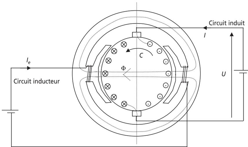
Figure 4.1 Constitution d'une machine à courant continu.
