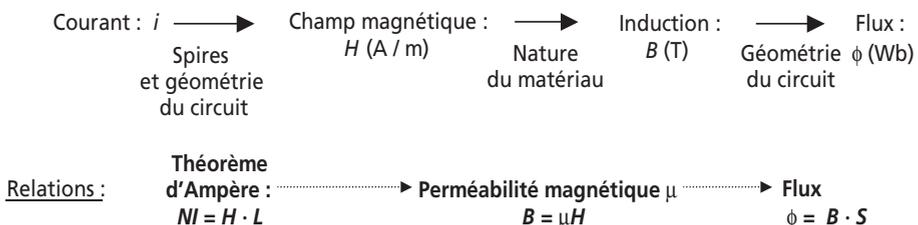
Figure 2.1 Les grandeurs du magnétisme en électrotechnique.
