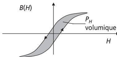
Figure 2.6 Cycle d'hystérésis.
