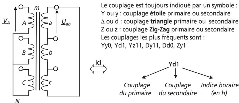
Figure 2.12 Représentation et notation conventionnelle des transformateurs triphasés.
