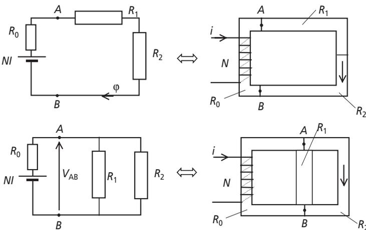
Figure 2.3 Circuits magnétiques hétérogènes série et parallèles.
