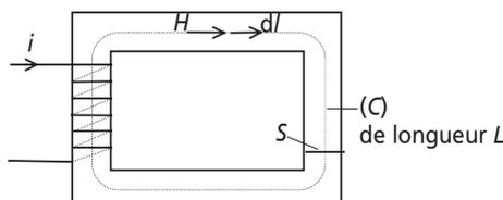
Figure 2.2 Morphologie classique d'un circuit magnétique bobiné.
