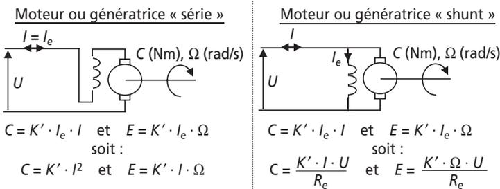
Figure 4.4 Schémas équivalents et relations importantes de la machine à courant continu.
