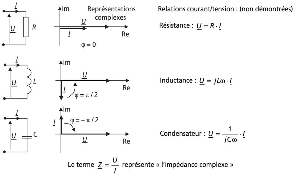
Figure 1.10 Courants et tensions complexes des principaux dipôles.
