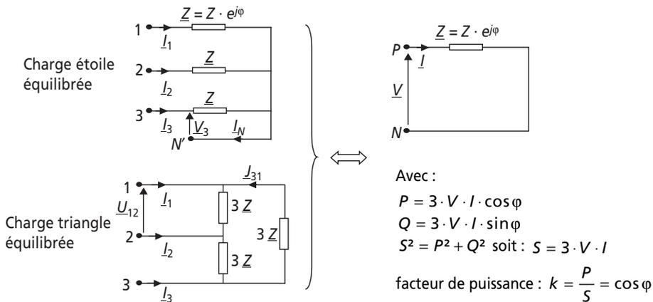
Figure 1.30 Schéma monophasé équivalent d'une charge équilibrée.
