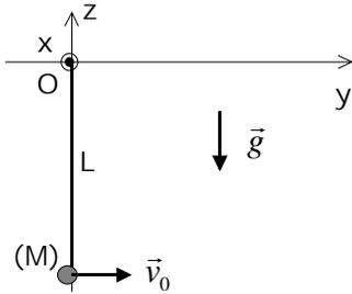
On considère un pendule simple constitué d'un fil inextensible de longueur  $L$  et de masse négligeable, auquel est suspendu un point matériel  $(M)$  de masse  $m$ .
