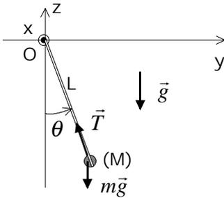
Tant que le fil reste tendu, la force de tension  $\vec{T}$  exercée par le fil ne travaille pas (elle reste perpendiculaire au déplacement).
