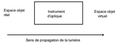
Un objet réel est un objet lumineux dont les divers points émettent des rayons formant un cône divergent.
