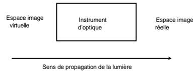
Un instrument d'optique donne d'un objet une image réelle si celle-ci peut être recueillie sur un écran. Si celle-ci ne peut être recueillie sur un écran, elle est virtuelle.
