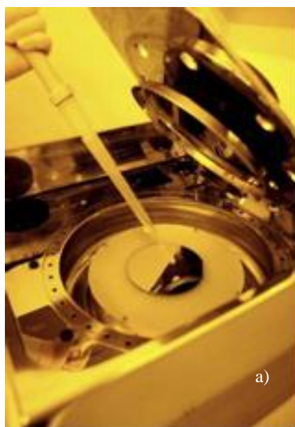
Photo I-1 : a) Le dépôt de résine par "spin coating" ; b) L'insolation UV de la résine
