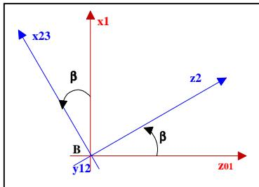
Dans un mouvement en rotation autour de l'axe  $(B, \vec{y}_{12})$  du repère  $R_2(\vec{x}_2, \vec{y}_2, \vec{z}_2)$  par rapport au repère  $R_1(\vec{x}_1, \vec{y}_1, \vec{z}_1)$ , tel que l'angle  $\beta(t)$  est défini par  $(\vec{x}_1, \vec{x}_{23})$ , le vecteur rotation  $\overrightarrow{\Omega_{R2/R1}} = \dot{\beta} \vec{y}_{12}$ .
