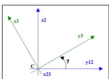
Dans un mouvement en rotation autour de l'axe  $(C, \vec{x}_{23})$  du repère  $R_3(\vec{x}_3, \vec{y}_3, \vec{z}_3)$  par rapport au repère  $R_2(\vec{x}_2, \vec{y}_2, \vec{z}_2)$ , tel que l'angle  $\gamma(t)$  est défini par  $(\vec{y}_{12}, \vec{y}_3)$ , le vecteur rotation  $\overrightarrow{\Omega_{R3/R2}} = \dot{\gamma} \vec{x}_{23}$ .
