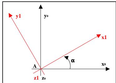
Dans un mouvement en rotation autour de l'axe  $(A, \vec{z}_{10})$  du repère  $R_1(\vec{x}_1, \vec{y}_1, \vec{z}_1)$  par rapport au repère  $R_0(\vec{x}_0, \vec{y}_0, \vec{z}_0)$ , tel que l'angle  $\alpha(t)$  est défini par  $(\vec{x}_0, \vec{x}_1)$ , le vecteur rotation  $\overrightarrow{\Omega_{R1/R0}} = \dot{\alpha} \vec{z}_{10}$ .
