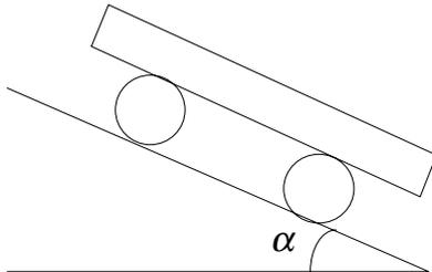
Un système est constitué de deux rouleaux cylindriques (masse  $m$ , rayon  $R$ ) sur lesquels est posé un plateau de masse  $M$ .
